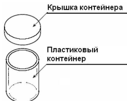
(Полиэтилен, рабочая температура: max 80°C)
