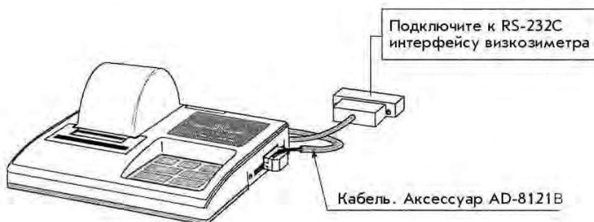
Компактный принтер AD-8121B
