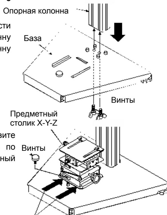
2 Извлеките закрепляющий винт из базы. Установите предметный столик X-Y-Z, надвинув его спереди по направляющим выступам. Закрепите предметный столик X-Y-Z с помощью ранее извлечённого винта.
