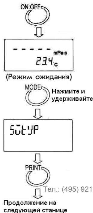
4 В режиме ожидания нажмите клавишу **MODE** и удерживайте её в течение не менее 2 секунд. Вискозиметр войдёт в режим установки функций **5vtyp**.
