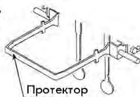
Если сенсорные пластины находятся на разном уровне относительно поверхности жидкости, выровняйте вискозиметр, используя регулировочные ножки. Уровень поверхности образца должен быть горизонтальным.
