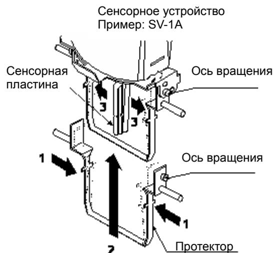
4 Извлеките 4 винта с задней панели рукоятки сенсорного устройства. С помощью этих четырёх винтов прикрепите сенсорное устройство к ползуну. Надёжно закрепите винты, чтобы впоследствии не возникало ошибок измерения, вызванных движением головки. Ползун является частью комплекта стойки.
