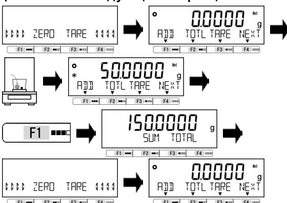
После отображения <SUM TOTAL> произойдёт автоматическое тарирование, затем весы перейдут к отображению массы и показания на дисплее будут обнулены.
