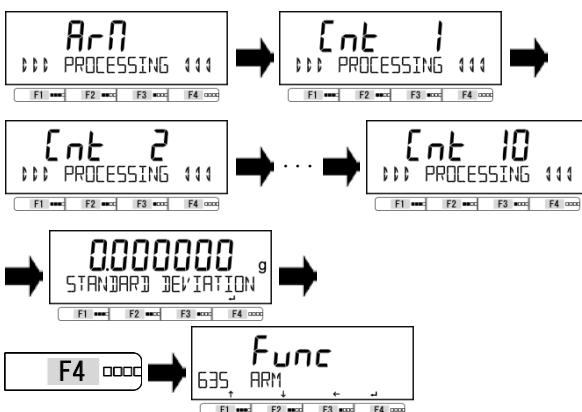
Показания дисплея будут меняться <ArM> → <Cnt 1> → <Cnt 2> → ... → <Cnt 10>, затем значение воспроизводимости (максимального разброса показаний) будет отображено на дисплее.
