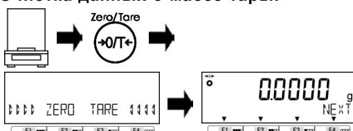
Снимите образец и тару с платформы весов, затем нажмите клавишу [Zero/Tare].
