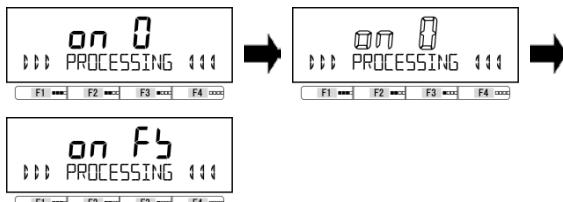
Изображение на дисплее будет меняться: <on 0> → “мигание <on 0>”. По завершению регулировки нулевой точки, изображение на дисплее автоматически изменится на <on FS>.
