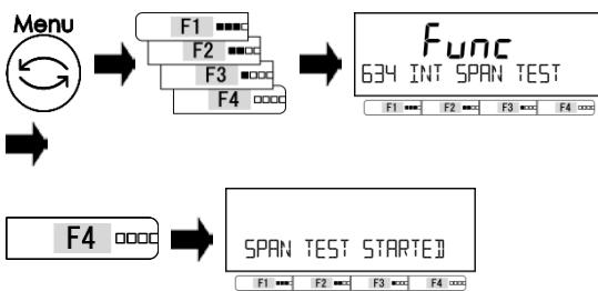
Нажмите клавишу [Menu], затем клавиши [F1-F4] для перехода к пункту <634 INT SPAN TEST>.
