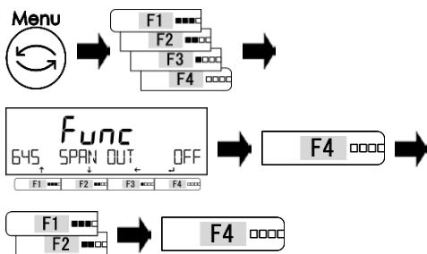
Нажмите клавишу [Menu], затем клавиши [F1-F4] для перехода к пункту <645 SPAN OUT>.
