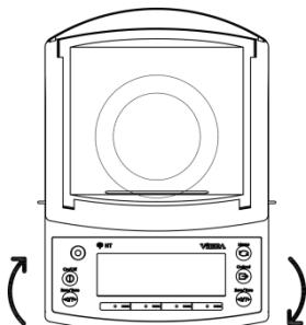
При выпуске с завода ножки снабжены двумя угловыми фиксаторами. Поверните их в направлении, указанном на рисунке слева, для освобождения ножек-регуляторов.
