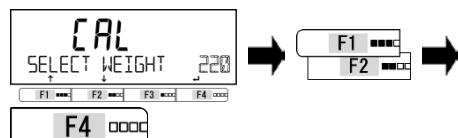
При помощи клавиш [F1/F2] выберите массу гири, используемой для калибровки.
