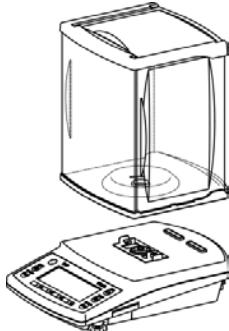
При снятии ветрозащиты не допускайте попадания грязи или жидкостей внутрь весов.
