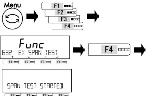
Нажмите клавишу [Menu], затем клавиши [F1-F4] для перехода к пункту <632 EX SPAN TEST>. Нажмите клавишу [F4] для запуска.
