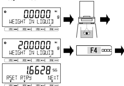
Удалите образец из сетки / корзинки и нажмите клавишу [Zero/Tare] для тарирования. Заполните ёмкость с сеткой / корзинкой водой / жидкостью, и снова нажмите клавишу [Zero/Tare] для компенсации выталкивающей силы воды / жидкости.
