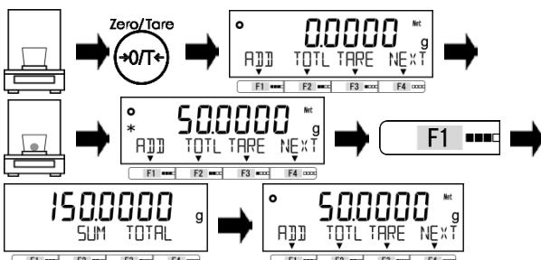
Снимите первый образец с весов и нажмите клавишу [Zero].
