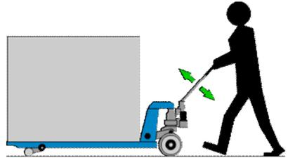
Груз поднимается при движении ручки гидравлической тележки.
