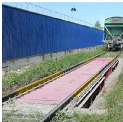
Железнодорожные (вагонные) весы «ВЖ» предназначены для статического взвешивания железнодорожных вагонов и взвешивания в движении - поосно и потележечно в зависимости от модификации.
