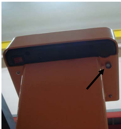
Рисунок 1 – Схема пломбировки от несанкционированного доступа и обозначение места для нанесения оттиска клейма.
