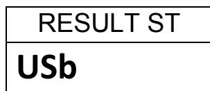
Для выбора другой опции, нажмите кнопку **[Dspl/↑]**. Доступны следующие опции: RESULT ST (сохранение результата), PST ST (сохранение параметров измерения), PST LD (загрузка параметров измерения), CONFIG ST (сохранение параметров конфигурации) и CONFIG LD (загрузка параметров конфигурации).
