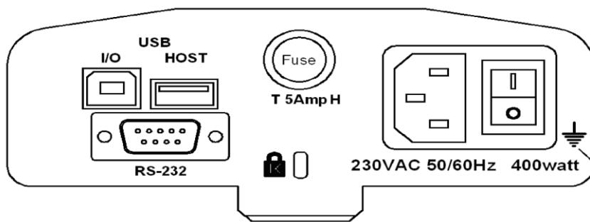
На задней панели находятся разъёмы интерфейсов передачи данных, гнездо предохранителя, крепление для замка и разъём кабеля питания.
