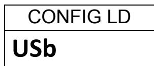
Нажмите кнопку **[Setup/Enter]** для запуска функции загрузки файла конфигурации. На дисплее отобразится имя первого по порядку найденного файла конфигурации.
