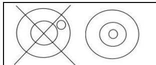
После установки PMB в подходящем месте, отрегулируйте горизонтальный уровень по пузырьковому индикатору, расположенному сзади. Для этого вращайте две задние ножки, пока пузырёк не окажется в центре круга.
