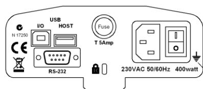
Подключите кабель питания к разъёму на задней панели. Главный выключатель расположен рядом с разъёмом питания на задней панели. Включите питание с его помощью.
