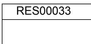
При помощи кнопок **[Dspl/↑]** и **[Test/↓]** можно листать список доступных файлов. Когда нужный файл результатов измерения будет выбран, нажмите кнопку **[Setup/Enter]** для удаления только выбранного файла. На дисплее будет мигать сообщение DELETED, и затем отобразится следующий доступный файл. Снова нажмите кнопку **[Setup/Enter]** для удаления этого файла, если желаете его удалить.
