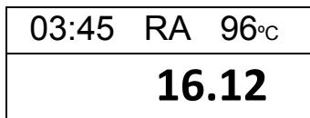
Если функция быстрого разогрева (RAPID) была активирована, на дисплее перед значением температуры будет отображён значок "RA".
