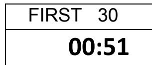
При этом таймер будет запущен. Таймер будет отсчитывать 10:00 для приведения температуры в камере к температуре окружающей среды. Следите за температурой в камере в течении этого времени.
