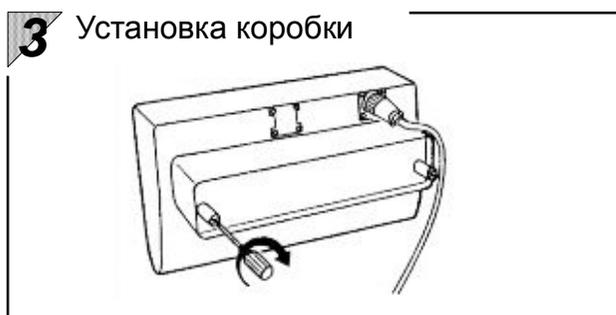
Подключите батареи с помощью коннектора и установите батарейную коробку на место в индикаторе.
