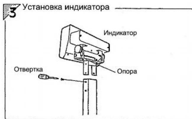
Установите и закрепите индикатор на стойке. Подключите кабель. При использовании питания от сети подключите силовой кабель.
