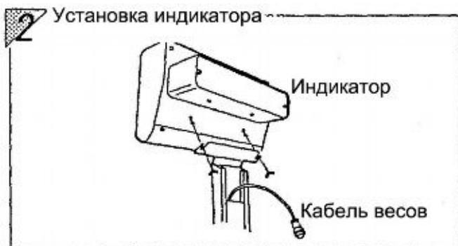
Протяните кабель весов через стойку весов и подключите к индикатору. Закрепите индикатор на стойке.
