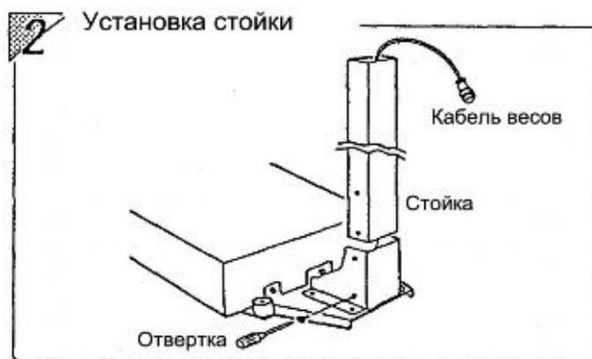
Протяните кабель весов внутри стойки. Установите стойку на основании и закрепите ее с помощью отвертки.
