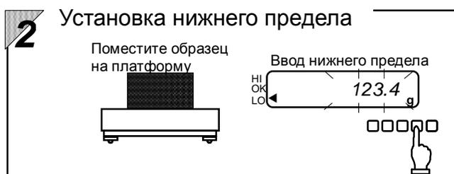
Поставьте на платформу образец, масса которого принимается за нижний предел, и нажмите кнопку Function.
