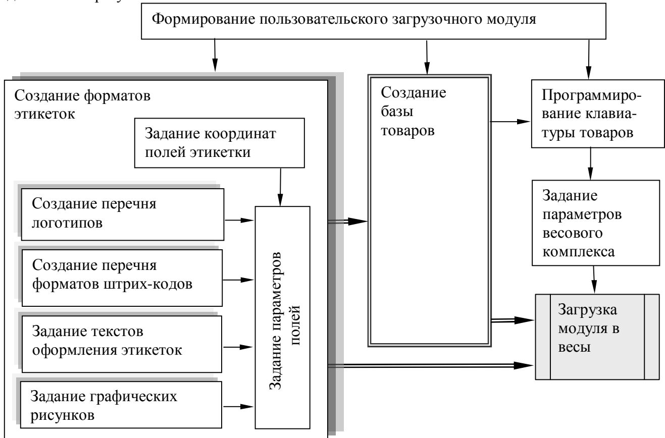
Рисунок. 8.1 - Схема создания загрузочного модуля
