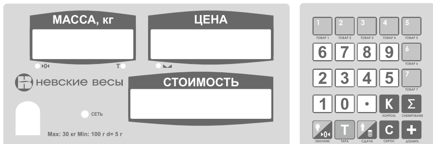
Рис. 2. Панель передняя весов модификаций ВСП-4Т(ТС)
