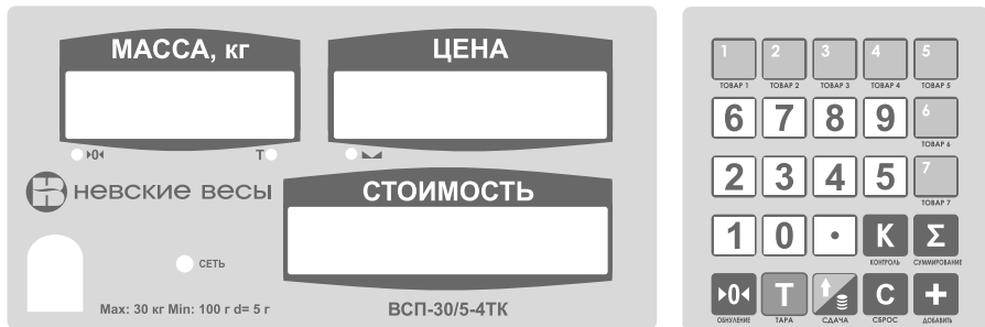
Рис. 4. Панель задняя блока индикации стойки весов модификаций ВСП-4ТС(ТКС)
