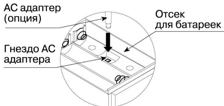
Закройте отсек для батареек. Для этого закройте крышку отсека, без перекоса задвинув ее по направляющим до щелчка.
