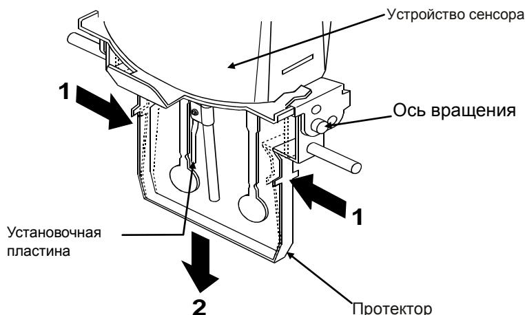
Слегка нажмите на левую и правую стороны рамки в направлении 1 для того, чтобы снять ось вращения. Потяните протектор в направлении 2.
