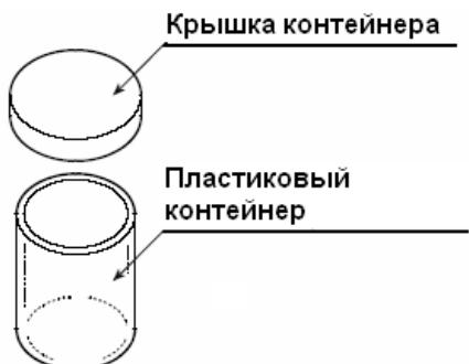
(Полиэтилен, рабочая температура: max 80°C)
