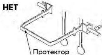
**Если сенсорные пластины находятся на разном уровне относительно поверхности жидкости, выровняйте вискозиметр, используя регулировочные ножки. Уровень поверхности образца должен быть горизонтальным.**
