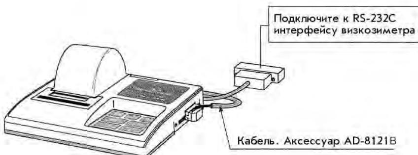
Компактный принтер AD-8121B
