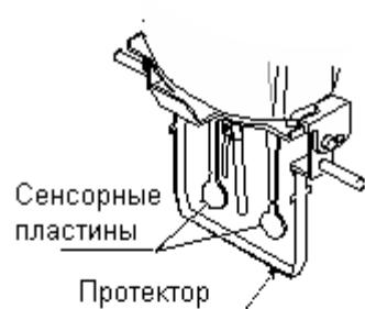
4 Сожмите зажимы, поддержите спереди сенсорное устройство и осторожно опустите сенсорные пластины над поверхностью образца.
