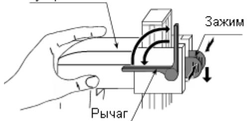
5 Опустите рычаг для закрепления сенсорных пластин.
