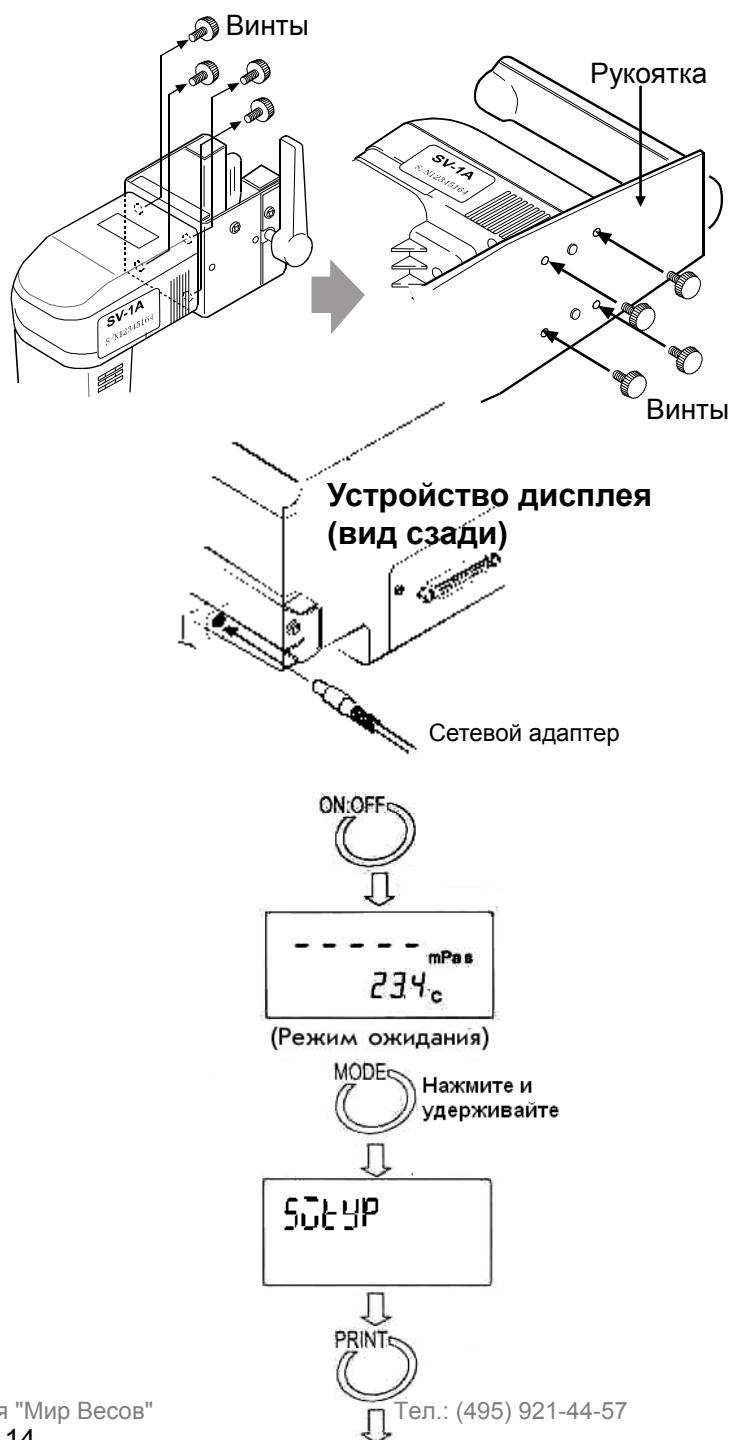
4 В режиме ожидания нажмите клавишу **MODE** и удерживайте её в течение не менее 2 секунд. Вискозиметр войдёт в режим установки функций **5vtyp**.
