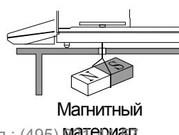
используйте подвес (в нижней части весов), чтобы подвесить материал подальше от воздействия магнита.
