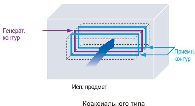
В AD4971 используется датчик коаксиального типа, который обычно используется в наше время из-за его высокой чувствительности и влагостойкости.
