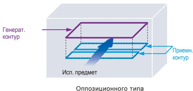
Металлодетектор оппозиционного типа позволяет использовать наконечник датчика большого размера и по запросу производить регулировку по высоте отверстия.
