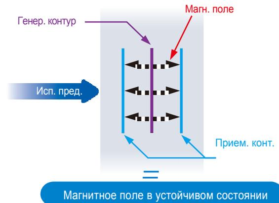
Если в предмете содержится магнитный металл (железо, Fe), магнитное поле у приемного контура увеличивается и возникает положительный дифференциальный сигнал.
