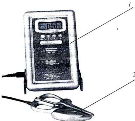
*Рис. 1 Внешний вид калипера : 1 - блок управления, 2-калипер.*
