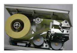
5. Закройте принтер и нажмите кнопку [Feed]. Принтер промотает несколько этикеток и распечатает тестовую этикетку.
