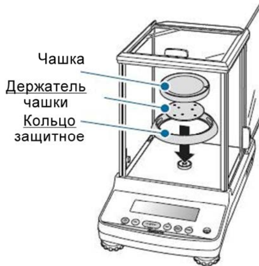
Рисунок 5 – Монтаж весов
