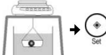
Поместите образец на сетку таким образом, чтобы он полностью погрузился в жидкость.
