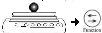
Установите на платформу образец, масса которого принимается за верхний предел, и нажмите кнопку [Function].
