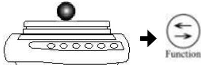
Установите на платформу образец, масса которого принимается за нижний предел, и нажмите кнопку [Function].
