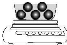
Поместите образец в тару. На дисплее отобразится только масса образца.
