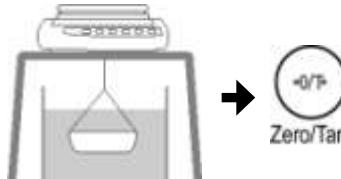
Установите ёмкость с водой под весами и погрузите пустую сетку в жидкость.
