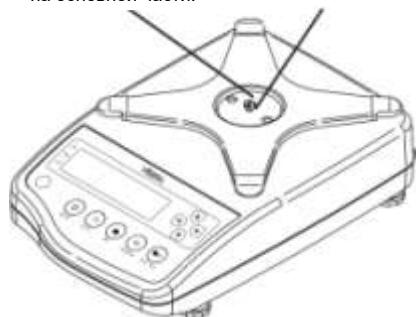
Установите основание на основную часть весов так, чтобы отверстия в основании совпали с выступами, и зафиксируйте винт.
