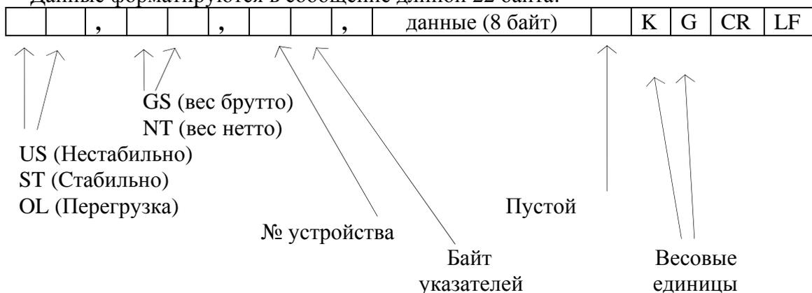
Байт указателей: сообщает о состоянии (включен или выключен) каждого из указателей на дисплее.
