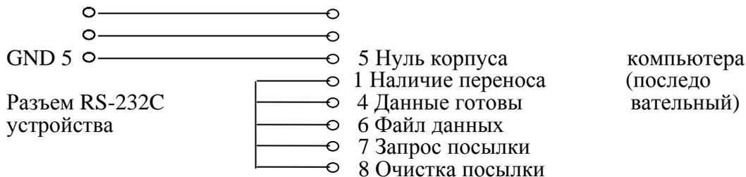
Схема соединения с дополнительным дисплеем (SERIAL):
