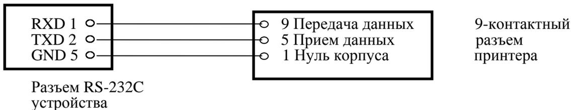
Схема соединения с принтером серии CP-7000:
