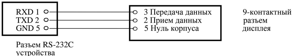
Схема соединения с принтером CAS TOP P-202:
