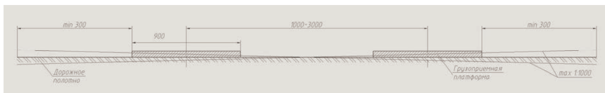
Рисунок 3.2 Схема установки грузоприемных платформ в поперечном направлении
