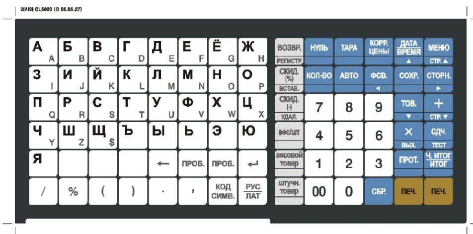
Рисунок 1.7 – Вид клавиатуры весов со стандартным набором клавиш
