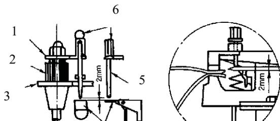
После опускания рычага необходимо приложить к педали дополнительное усилие, чтобы сработал микровыключатель. Зазор между наконечником 5 микровыключателя и неподвижной планкой 4 требует специальной регулировки, т.к. в противном случае процесс сварки может вообще не начаться.
