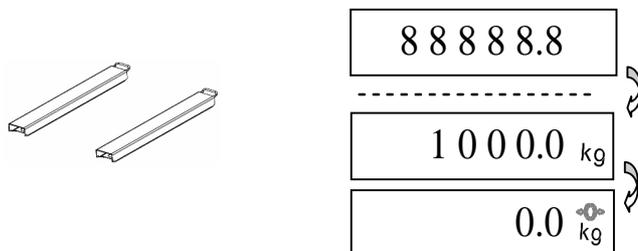
Включить весы. После прохождения теста на индикаторе последовательно высветится НПВ платформы (например, 1000 кг) и затем нулевая масса.
