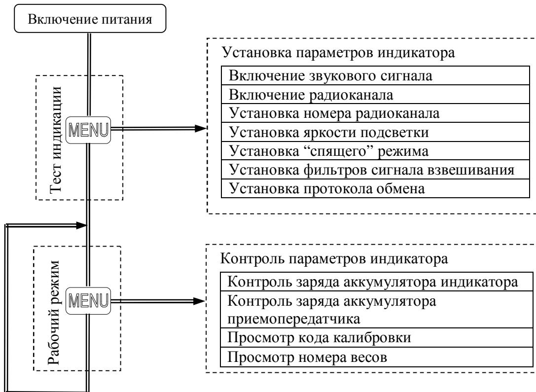
Рис. 5.1 - Установка и контроль параметров весов
