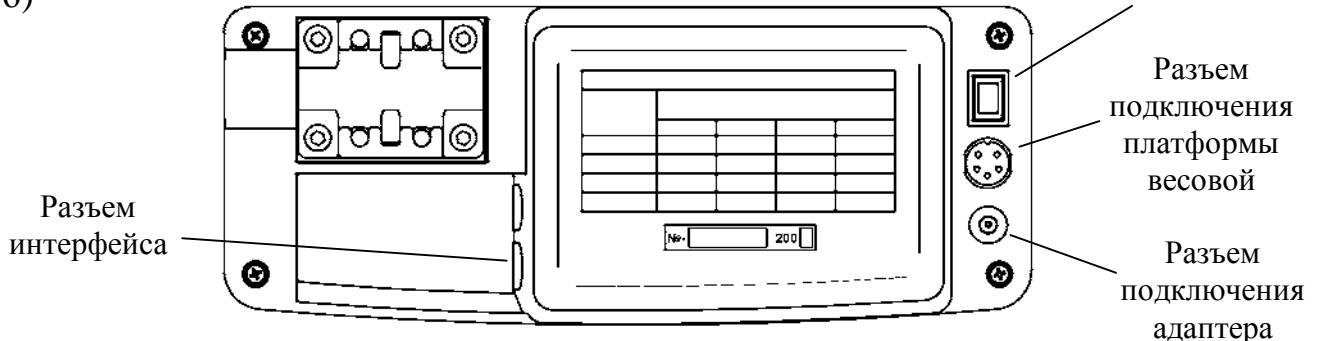
Рис. 3.1 - Индикатор WI 4D-A (WI 4D-A.W)
