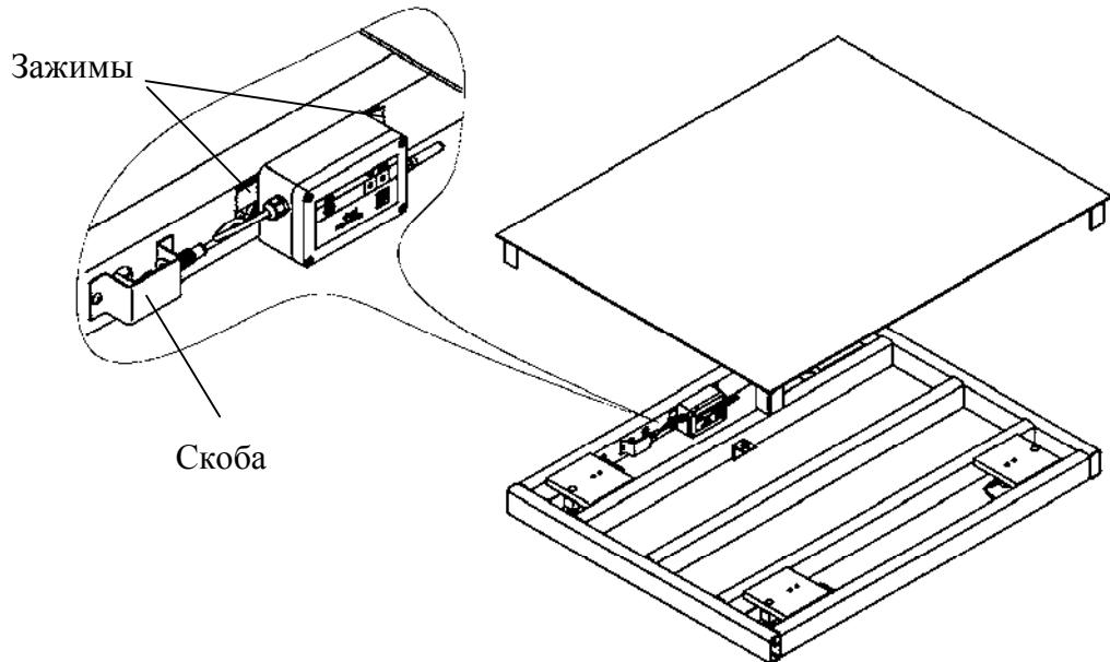
Рис. 4.4 - Подключение приемопередатчика к внутреннему
