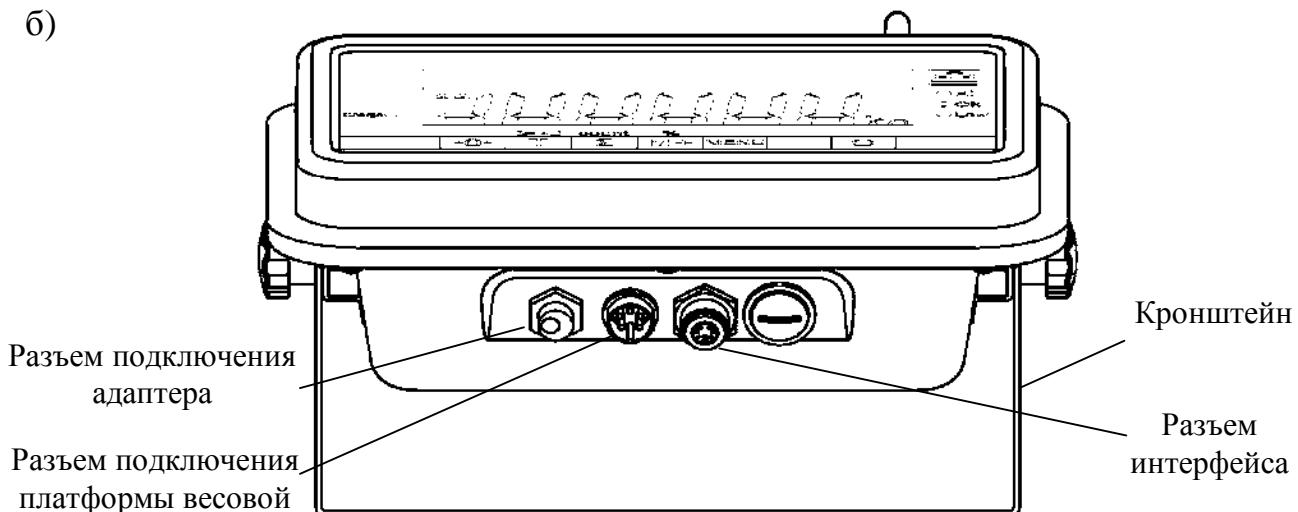
Рис. 3.2 - Индикатор WI 4D-AB (WI 4D-AB.W)
