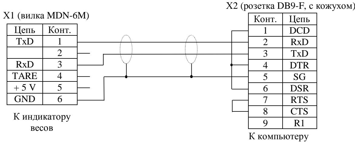
Рис. 7.1 - Кабель для подключения весов к компьютеру
