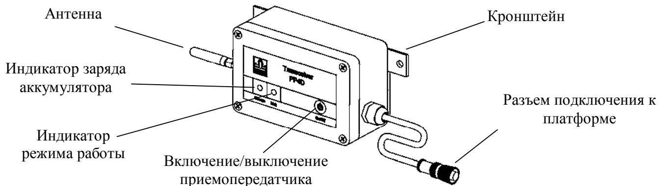
Рис. 3.3 - Приемопередатчик PP 4D (PP 4D.S)
