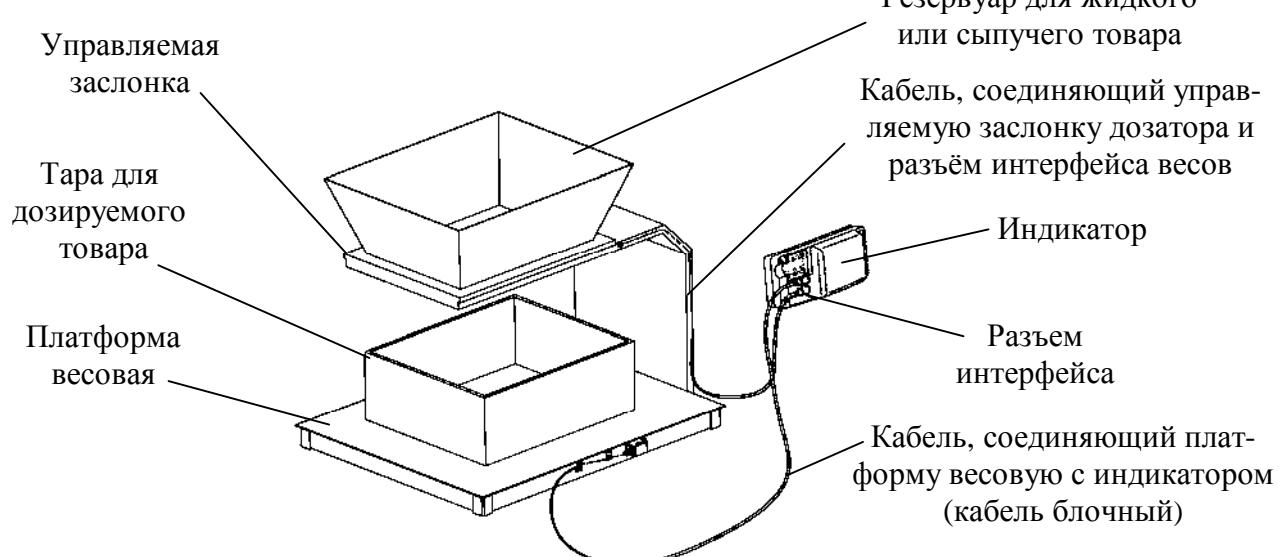
Рис. 5.2 - Подключение весов к устройствам дозирования
