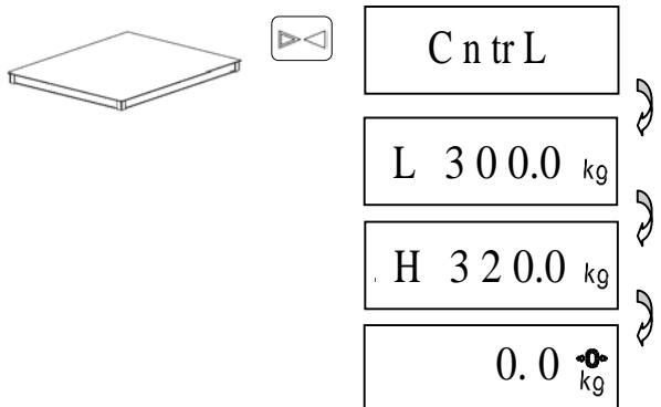
Включить весы и во время прохождения теста нажать и удерживать около 3-х секунд кнопку . На индикаторе последовательно высветится следующая информация: надпись «CntrL», установленные значения минимальной массы (L), и максимальной массы (H) и затем нулевая масса.
