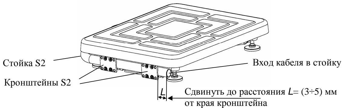
Рисунок 6.2 - Крепление круглой вращающейся стойки к основанию весовой платформы ТВ-S_A
