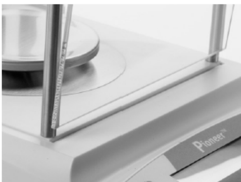
2) Установите стенки: вставьте нижний край в паз, затем прижмите верхний край до срабатывания защелки.
