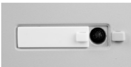
Переключатель не опломбирован
