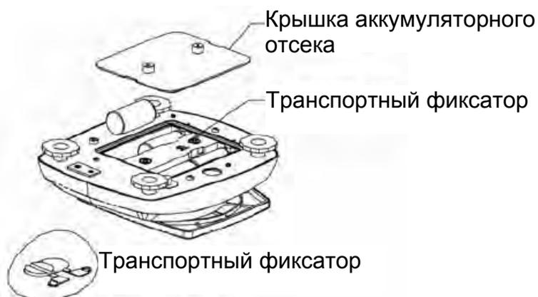
Рис. 2-2. Установка элементов питания
