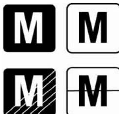
Приборы для измерения массы, прошедшие поверку на месте изготовления, имеют один из показанных слева знаков на упаковочной этикетке и стикер зеленого цвета с буквой «М» (метрология) на паспортной табличке. Такие приборы готовы к эксплуатации сразу после получения.
